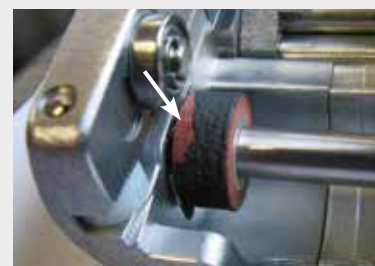
② Verschleißmarkierung Reibrad Rot = Austausch erforderlich
