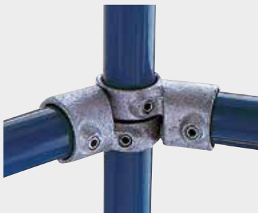
Best.-Nr. 0520 4801 00 (10) Eckgelenk mit Durchgang, zweigeteilt, daher verstellbar von 90° - 180°. Bei Verwendung für Knotenpunkt Handlauf/Stütze: Kunststoffstopfen Best.-Nr. 0520 0400 10* mitbestellen. * Set = 10 Stck. CHF 67.00 p. Stck.
