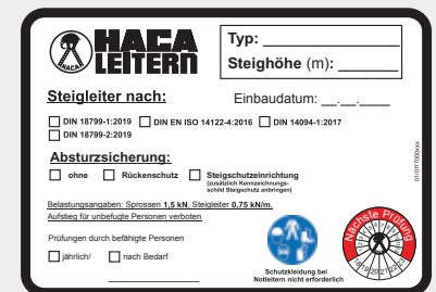
Typ 0173.10 / Typ 0174.10 Kennzeichnung der Klasse des Anwenders nach DIN 18799:2019
