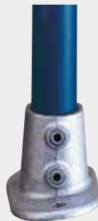
Best.-Nr. 0520 2300 00 (28) T-Stück , Verstellbereich 0° - 11°, Anfangsstützen/Knieleiste (auch für Handlauf/Mittelstütze). CHF 40.00 p. Stck.
